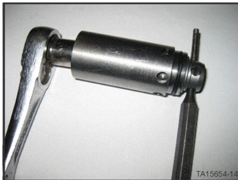
Jam Nut Torque 135 \pm 20 in-lbs ( 1.5 \pm 0.2 daNm)
